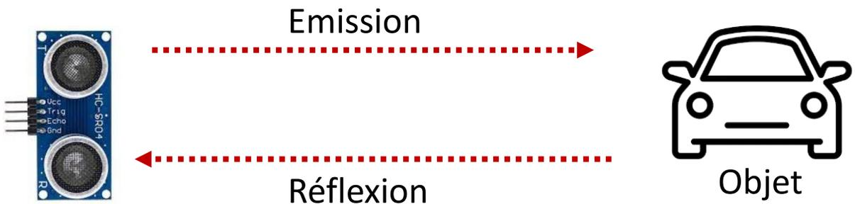
Un capteur à ultrasons est un appareil qui utilise des ondes ultrasonores (ondes inaudibles de fréquence supérieure à 20kHz) pour mesurer la distance entre lui-même et un objet. Il est composé d'un émetteur et d'un récepteur.
