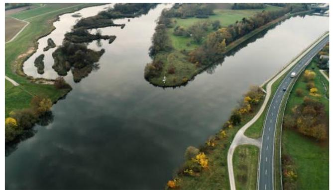
**Fig. 2 : Bifurcation d'une rivière.** Comme en électricité, la rivière se sépare en deux, chaque branche garde la même vitesse qu'en amont, mais le volume d'eau circulant a diminué. Donc le débit diminue.
